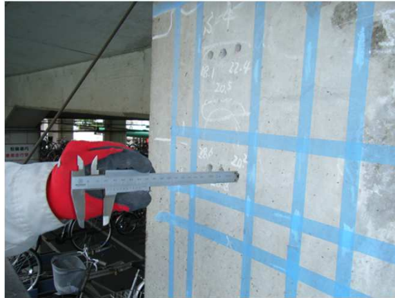
M型ノギスのデプスバーと本尺の端部を用いて測定
