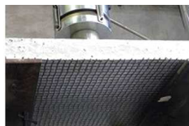
押抜き試験前
