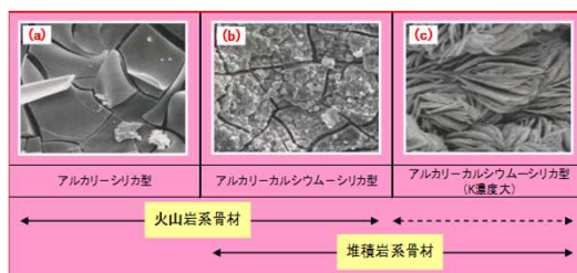
SEMにより観察されるアルカリ骨材反応生成物の形状例
