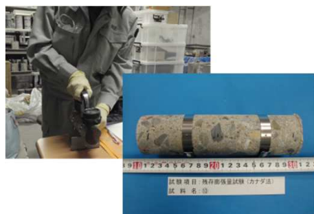
残存膨張量測定状況
