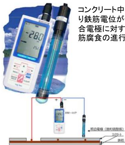
コンクリート中の鉄筋が腐食すると、アノード反応により鉄筋電位が低下(卑な方向へ変化)する。そこで、照合電極に対する鉄筋の電位を測定することにより、鉄筋腐食の進行を推定する。
