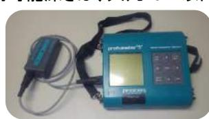
渦電流方式 測定機器
