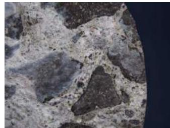
中央左の粗骨材は白色生成物によりほぼ完全に覆われている。また、その右側の粗骨材には顕著な反応リムが認められる。
