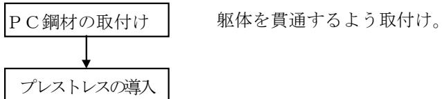
図 縫合工法(プレストレス導入工法)の施工フロー
